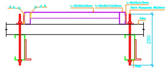
DETALHE DE FIXAÇÃO DA PASSARELA
